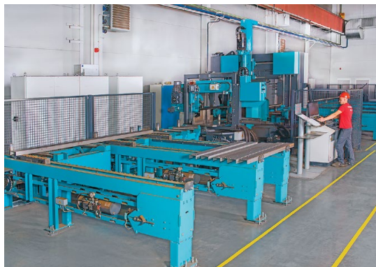
Линия распила, сверления и фрезерования металлопроката (1 станок)
