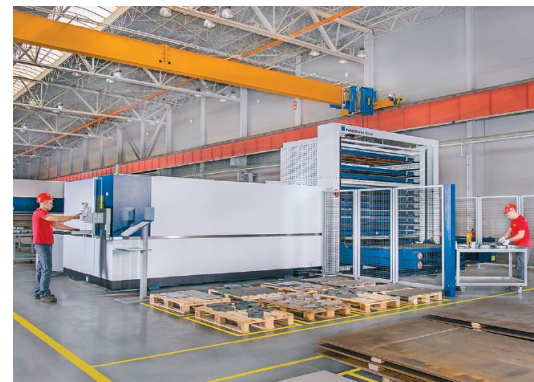
Станок лазерной резки листового металла (2 станка)
