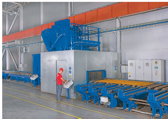
Автоматизированная дробемётная установка очистки металла (1 станок)
