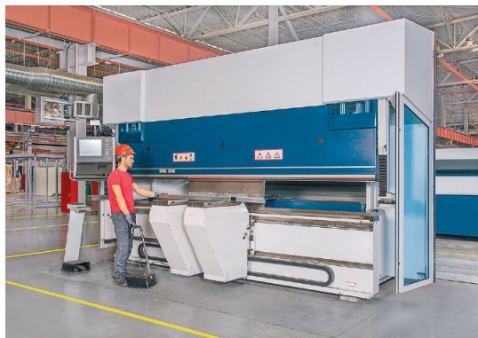
Станок для гибки листового металла (2 станка)
