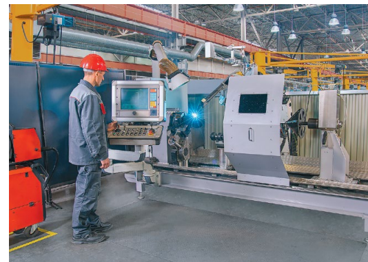
Установка автоматизированной сварки трубопроводов (2 станка)
