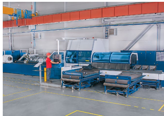
Станок лазерной 3D-резки труб и металлопроката (2 станка)
